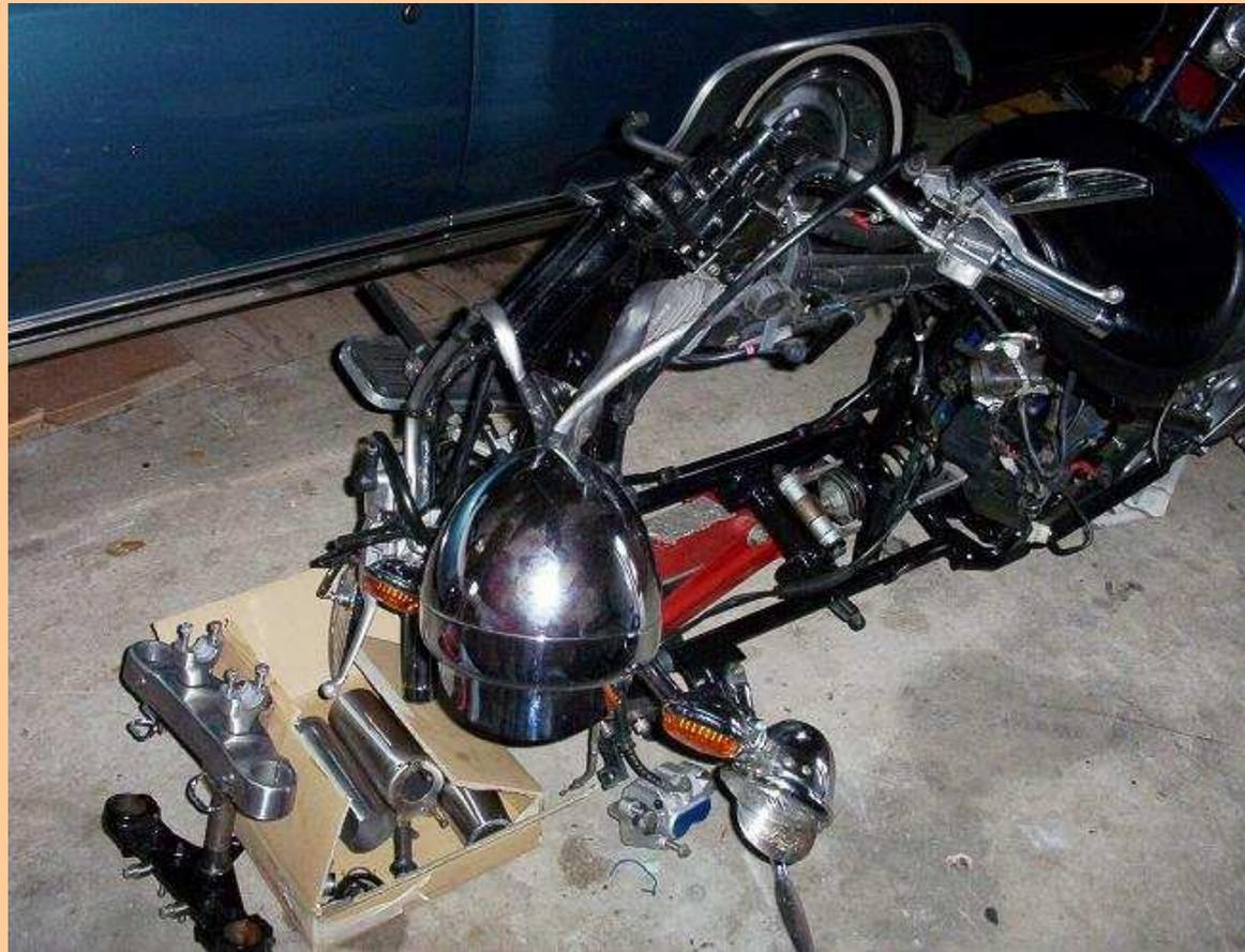
Il faut enlever les vieilles cages de roulement, a l'aide d'un tournevis solide...
