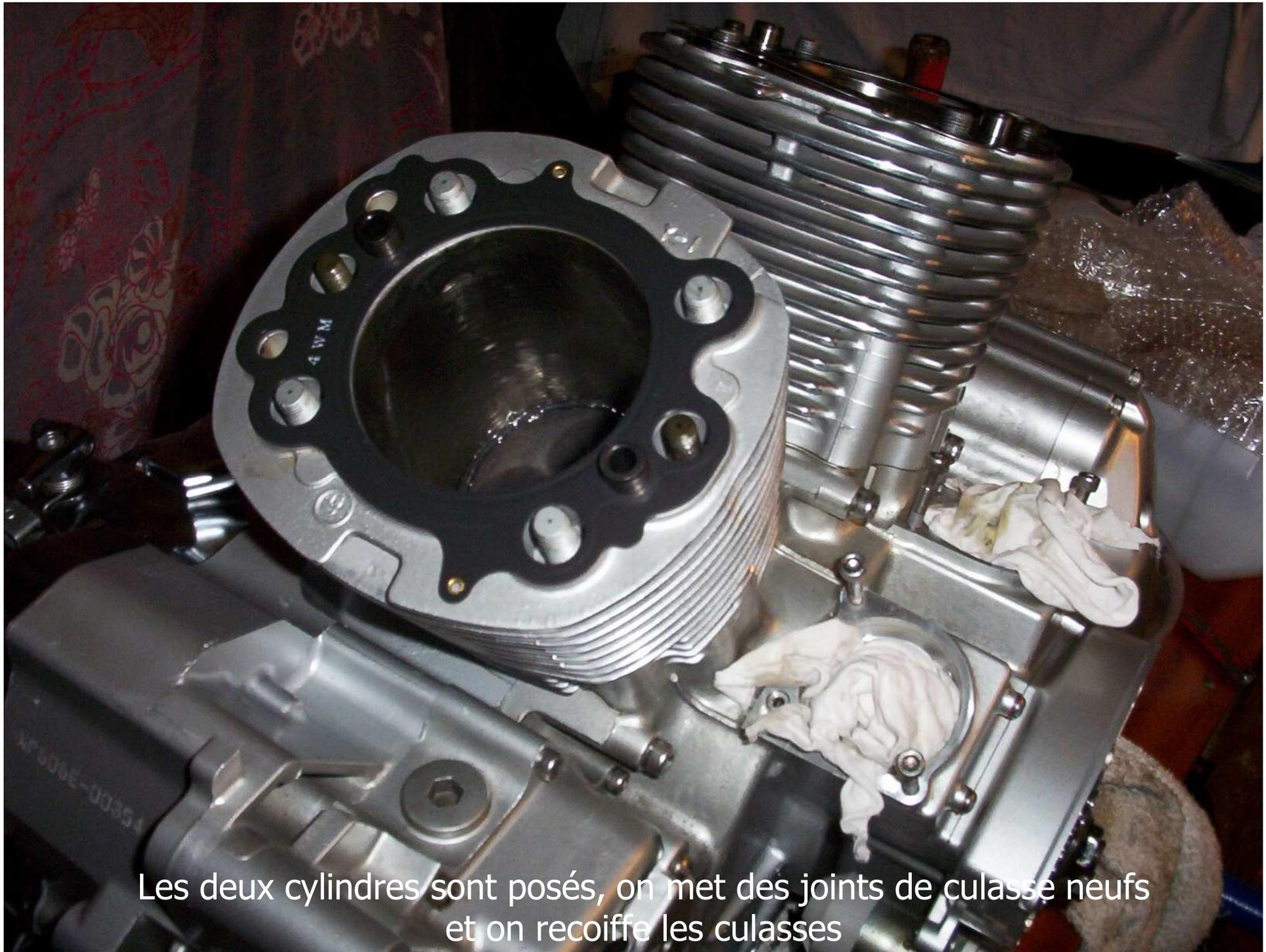
Les deux cylindres sont posés, on met des joints de culasse neufs et on recoiffe les culasses
