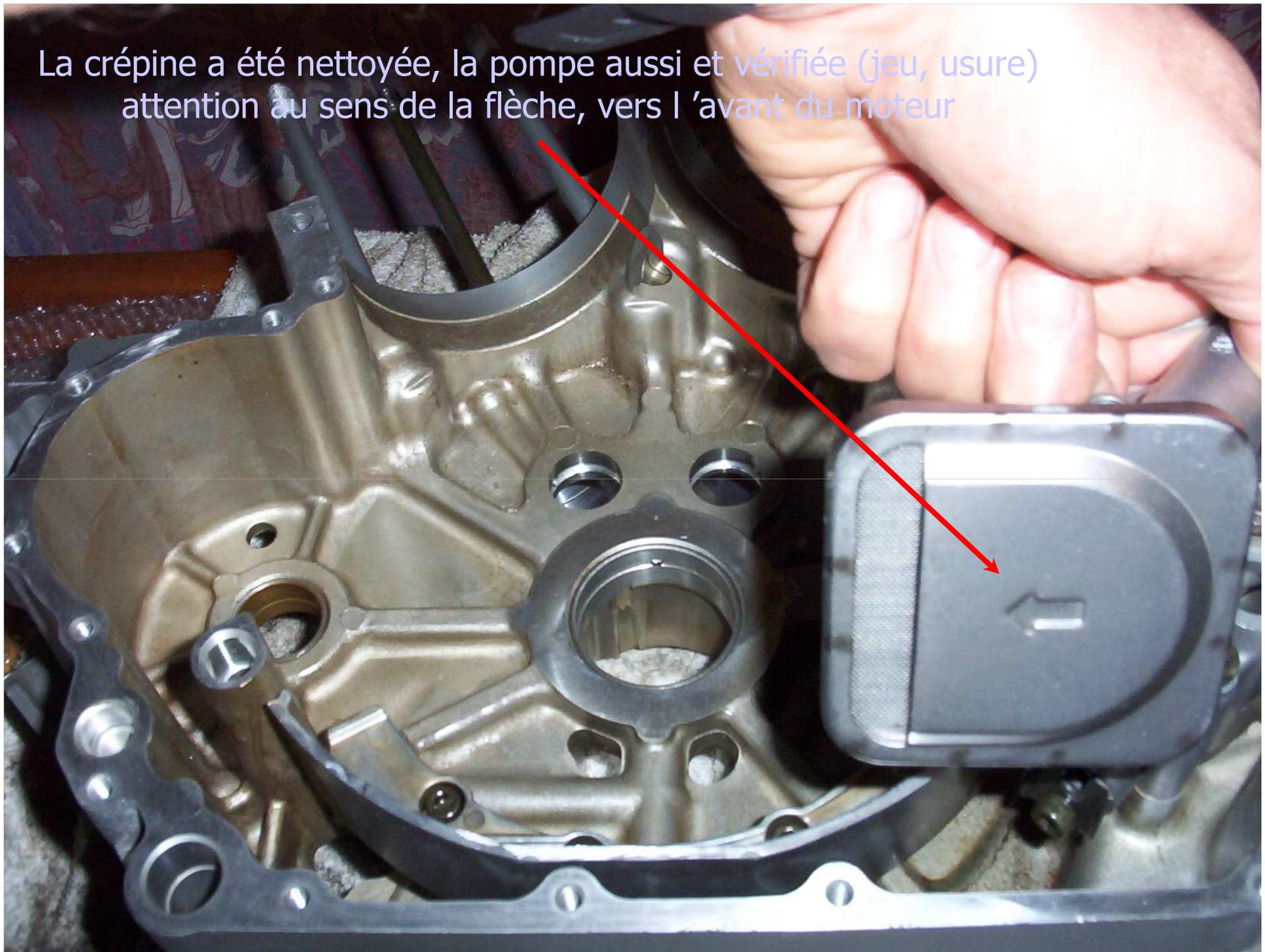
On met une goutte de « freinilet » sur les vis de la crépine
