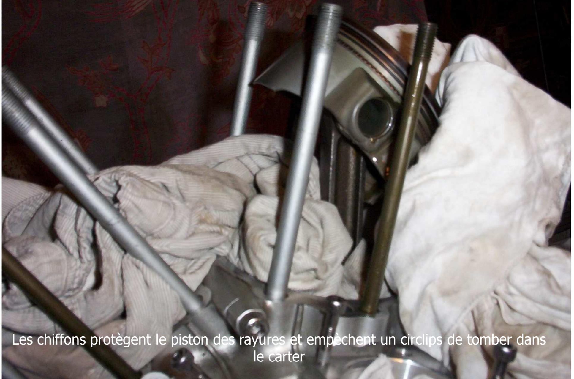
Les chiffons protègent le piston des rayures et empêchent un circlips de tomber dans le carter
